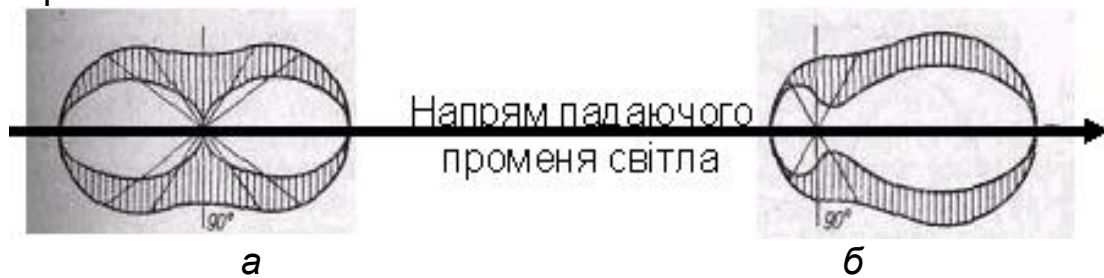
Рис. 7.7 – Діаграми Мі, які характеризують розсіяння і поляризацію світла частинками малих (а) і великих (б) розмірів.
