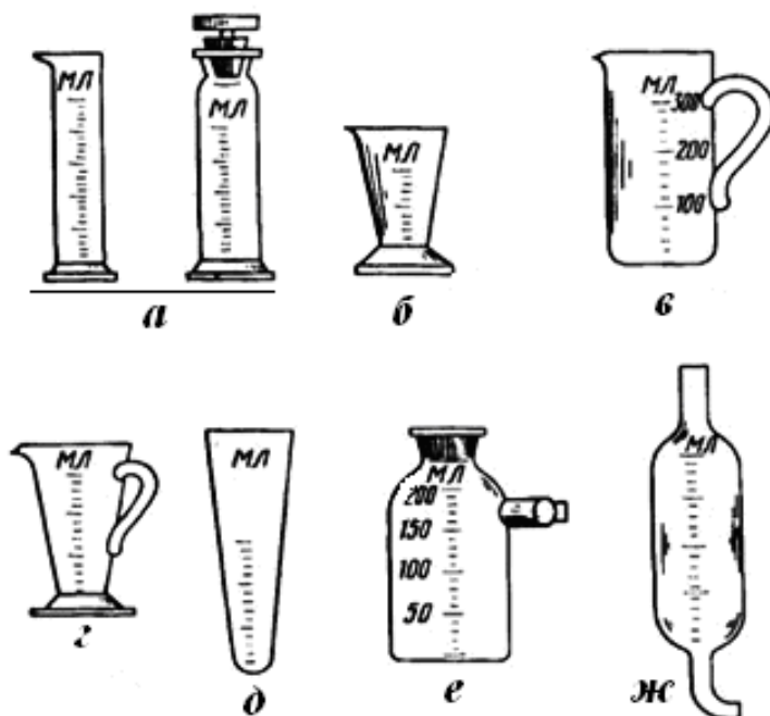
Рис. 3 – Мірні циліндри, мензурки та інший мірний посуд а – мірні циліндри; б – мензурка; в, г – кухлі; д – конус Імгоффа; е – мірна склянка для вакуумного фільтрування; ж – мірний балон
