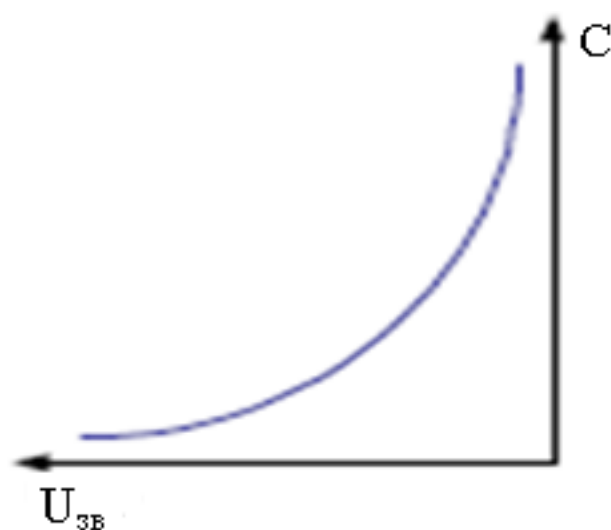
Рисунок 3.7 - Залежність величини бар'єрної місткості від прикладеної зворотної напруги
