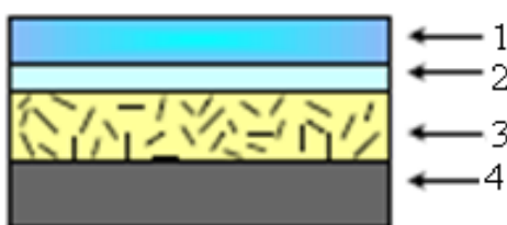
Рисунок 6.5 - Конструкція РК індикатора, що працює на віддзеркалення
