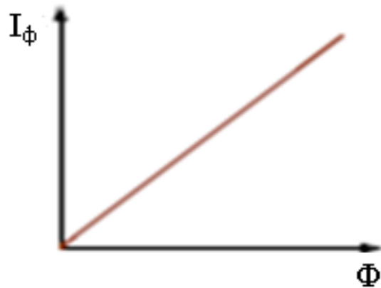
Рисунок 3.11 - Залежність фотоструму фотодіода від світлового потоку
