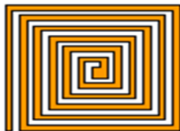
Рисунок 5.3 - Вигляд плівкової котушки індуктивності
