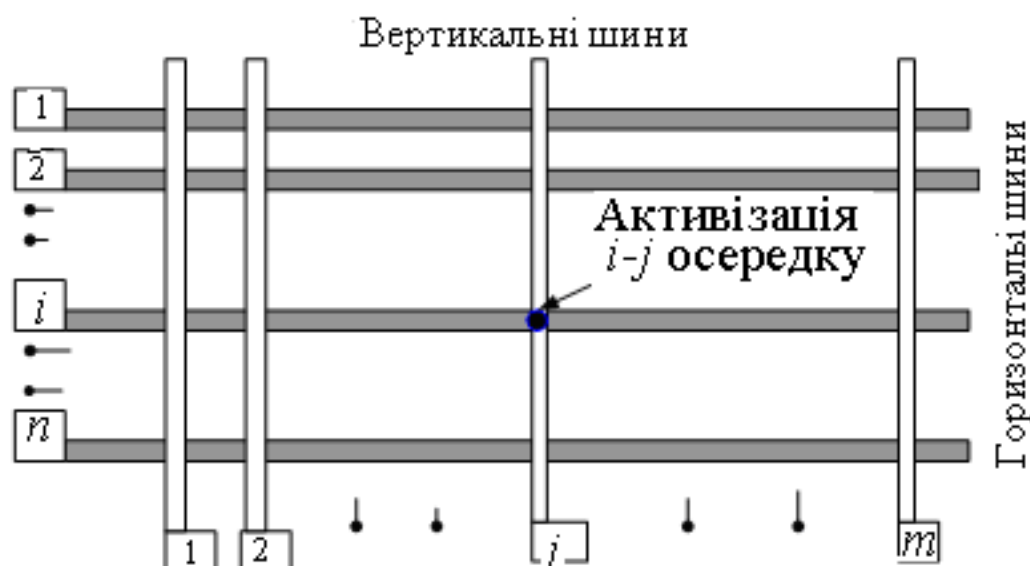
Рисунок 6.11 - Принцип керування екранними панелями
