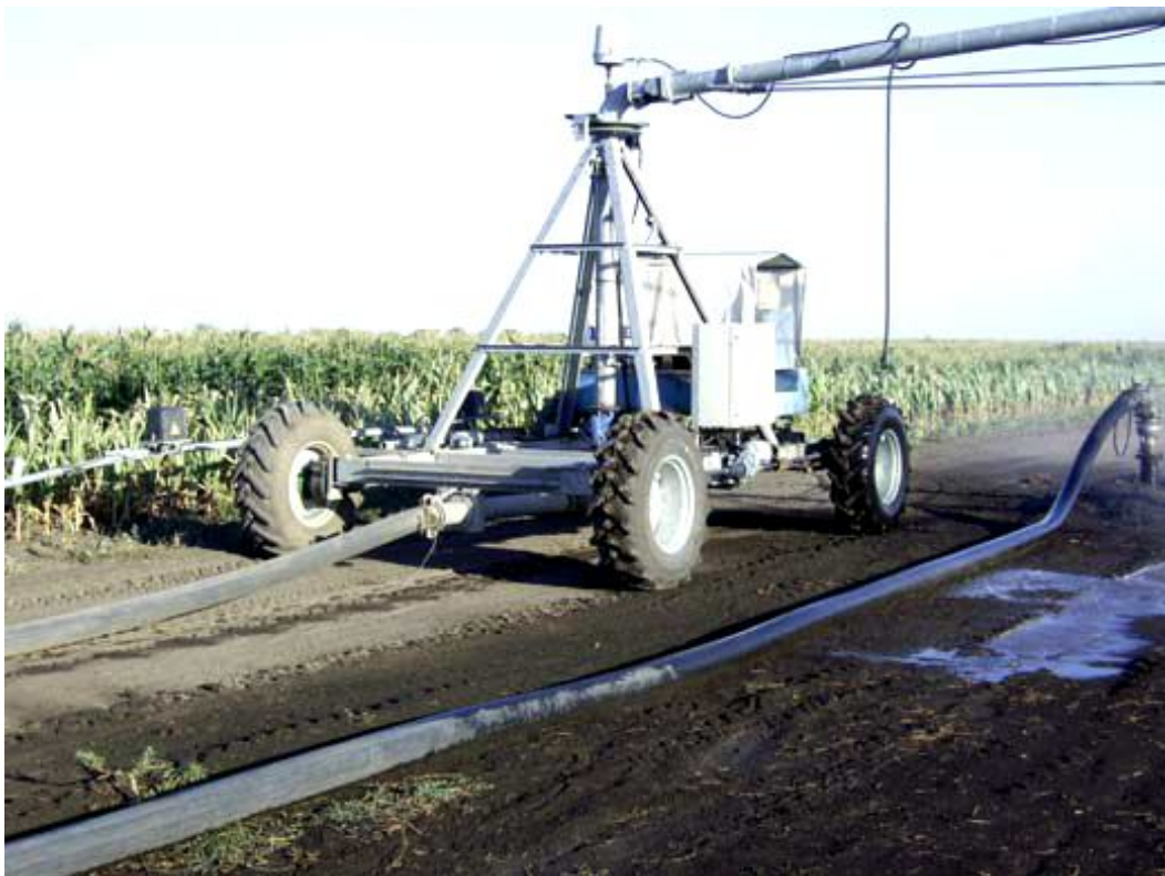
Рис. 4.1 Загальний вигляд водопровідного трубопроводу дощувальної машини "Centerliner 168 CLS"
