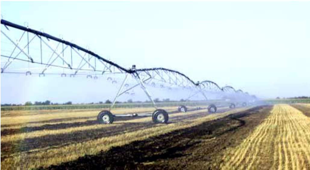
Рис. 4.1 Загальний вигляд водопровідного трубопроводу дощувальної машини "Centerliner 168 CLS"
