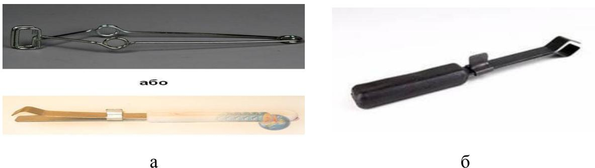
Рис. 5 – Тримачі пробірок: а – металевий; б – дерев’яний
