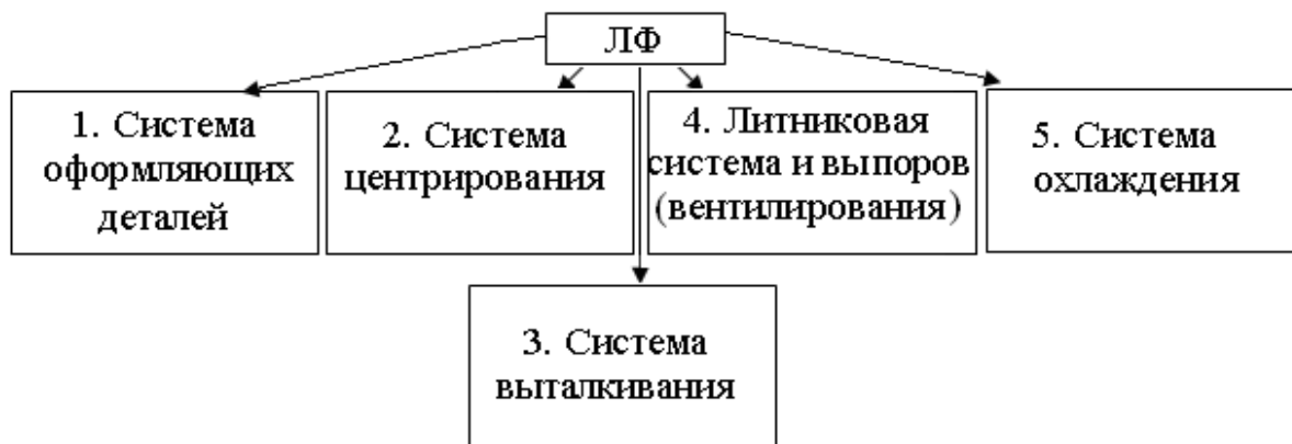
Рисунок 2.1 – Схема узагальненої структури ливарної форми
