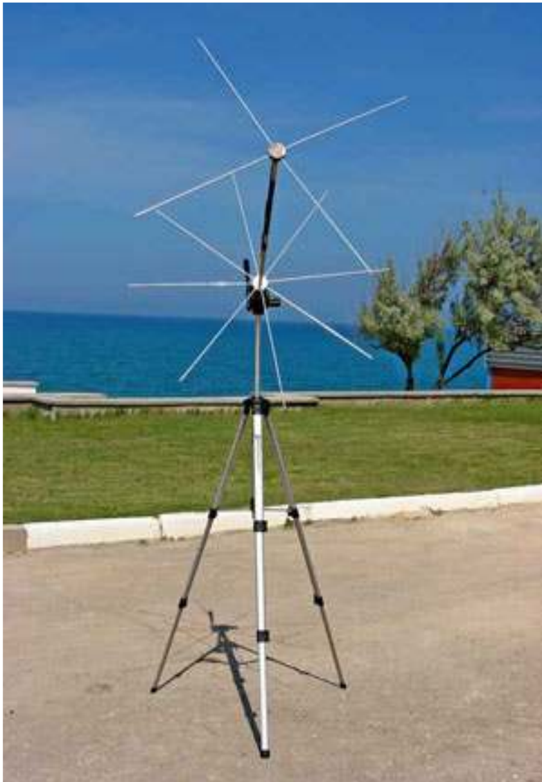
Рис. 3.10 – Хрестоподібна переносна антена
