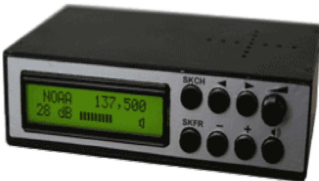
Рис. 3.14 – Загальний вигляд приймача
