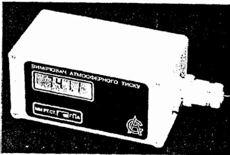
Рис. 3.32 – Вимірювач атмосферного тиску цифровий БАР
