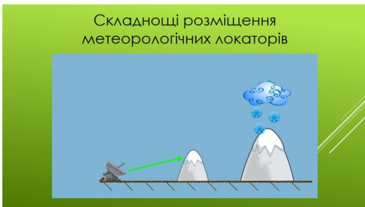
Рисунок А.4 – Особливості побудови радіолокаційного поля в гірській місцевості
