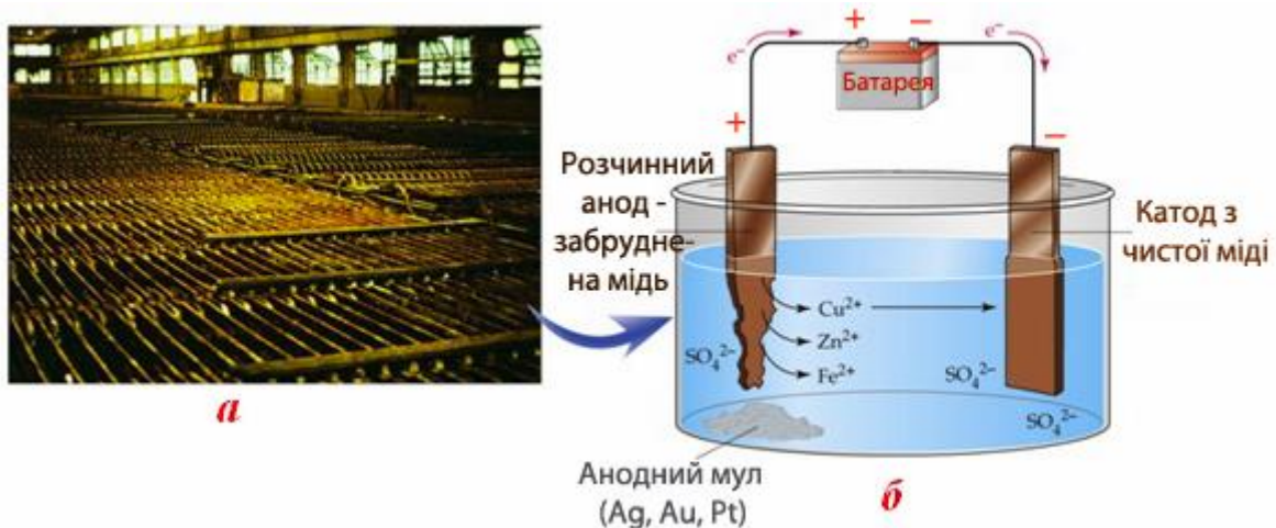
Рис. 15 – Електролітичне рафінування міді: а) виробничий процес рафінування; б) схема процесу
