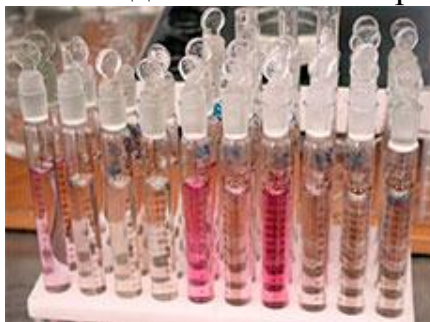
Рис. 30 – Наближене визначення вмісту Нітрогену нітритів у воді
