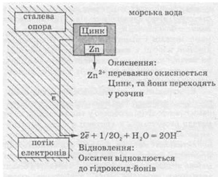
Рис. 23 – Схема дії протекторного захисту металу.
