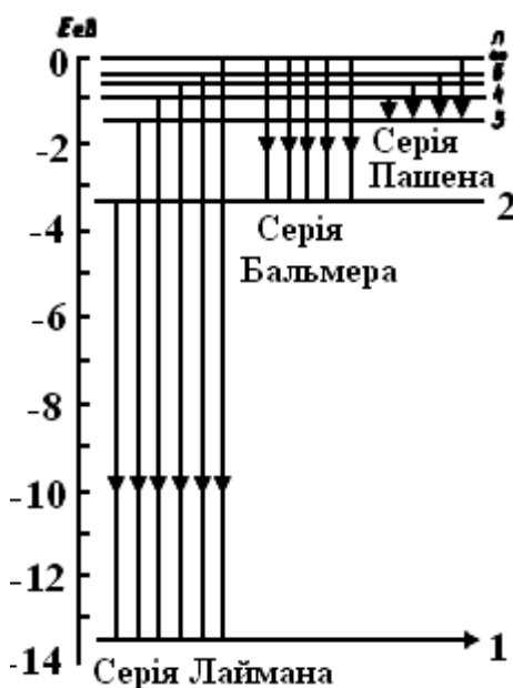
Рис. 2.6 – Схема енергетичних рівнів атома водню
