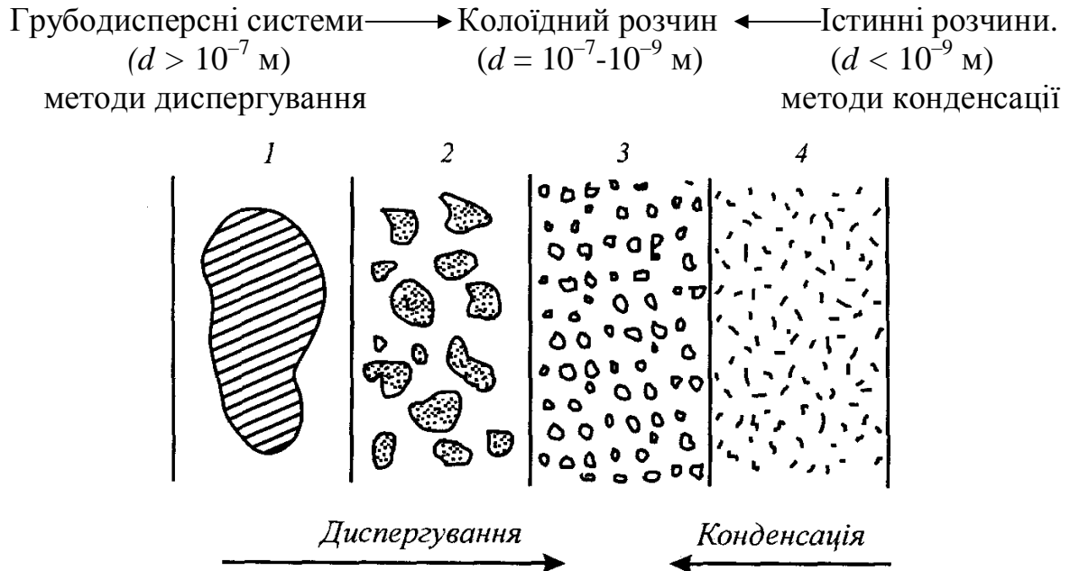
Рис. 3 – Диспергаційні та конденсаційні методи одержання колоїдних розчинів:
