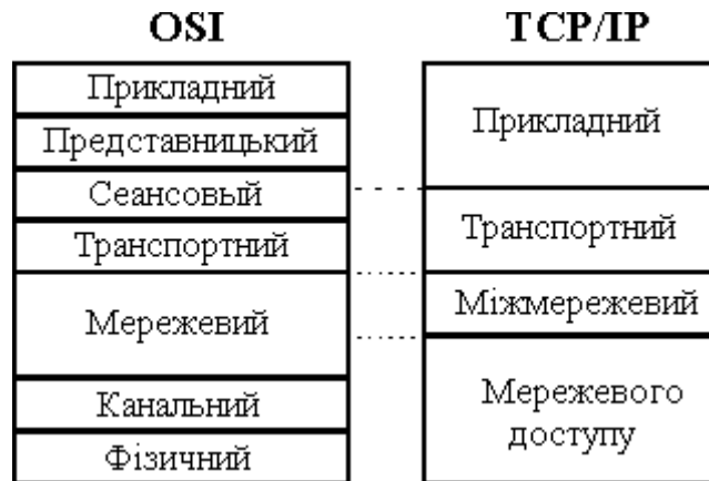
Рисунок 1.18 – Співвідношення рівнів стеків OSI і TCP/IP
