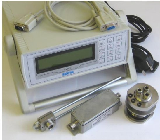
Рисунок 3.1 – Кварцевий вимірювач товщини плівки КВТП-5
