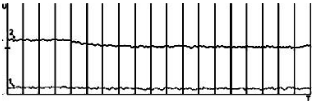
Рисунок 2.7 - Форма сигналів "синього" і "червоного" каналів при реєстрації потоку світла від еталонної лампи і перешкоди у вигляді лампи розжарювання
