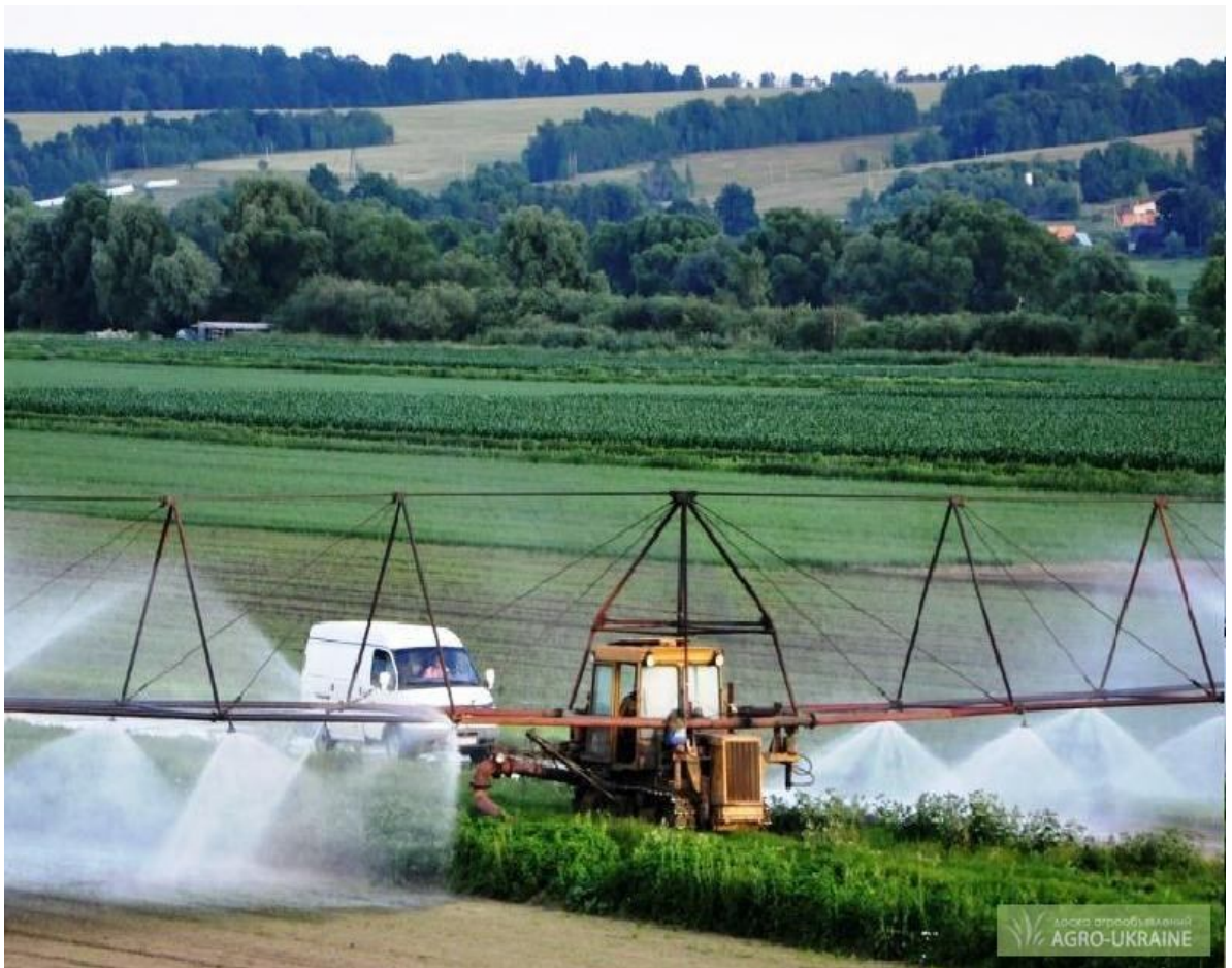
Рисунок 5.1 – Двоконсультний дощувальний агрегат ДДА-100МА
