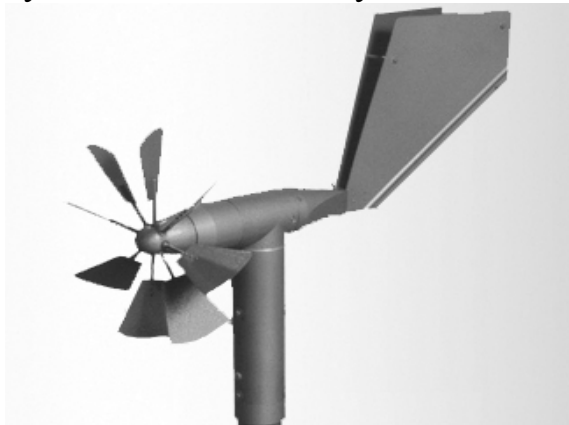
Рис. 17 - Конструкція флюгарки з крильчаткою.
