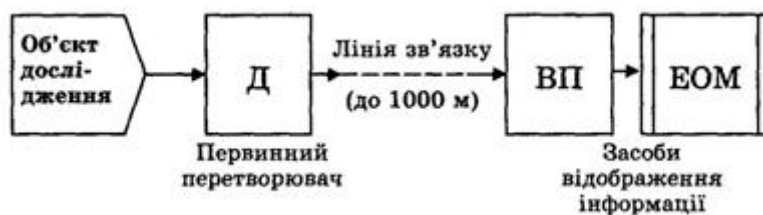
Рис.21 Схема дистанційної передачі сигналів вимірювальної інформації
