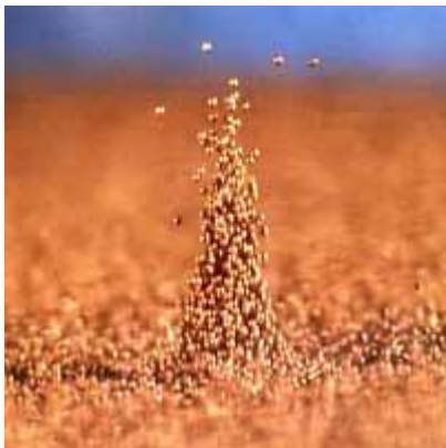
Рис.3. «Кипіння» гранульованої системи у полі віброприскорення.
