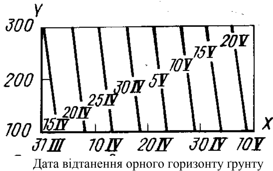
Рис.11.3 – Графік для розрахунку дати просихання ґрунту до м'якопластичного стану
