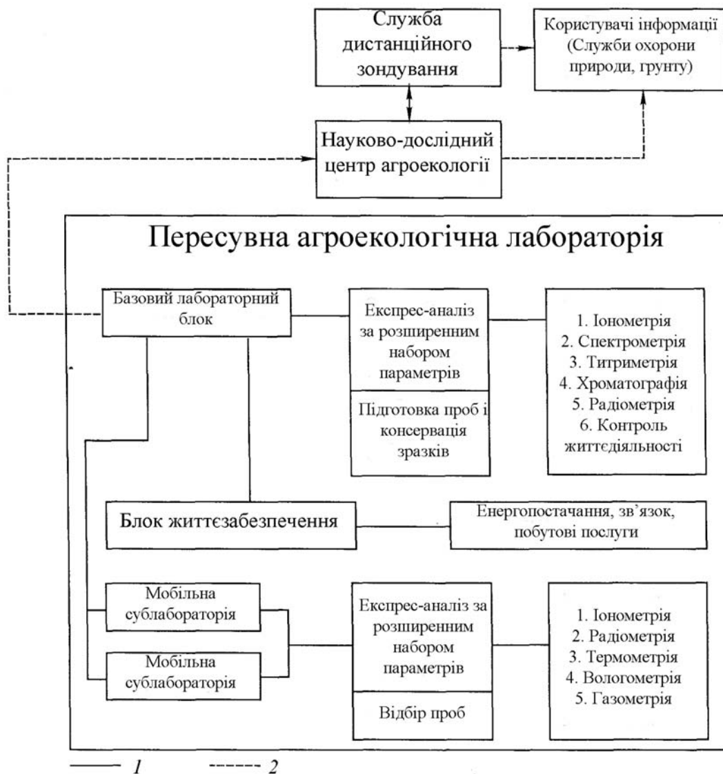
Рисунок 9.2 – Структурні елементи пересувної агроекологічної лабораторії:
