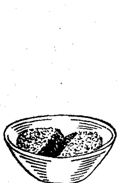
Рис. 3.3 – Визначення текучого стану ґрунту
