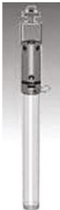
Рис.5.4 Гравітаційний керновий пробовідбірник (грунтова трубка).
