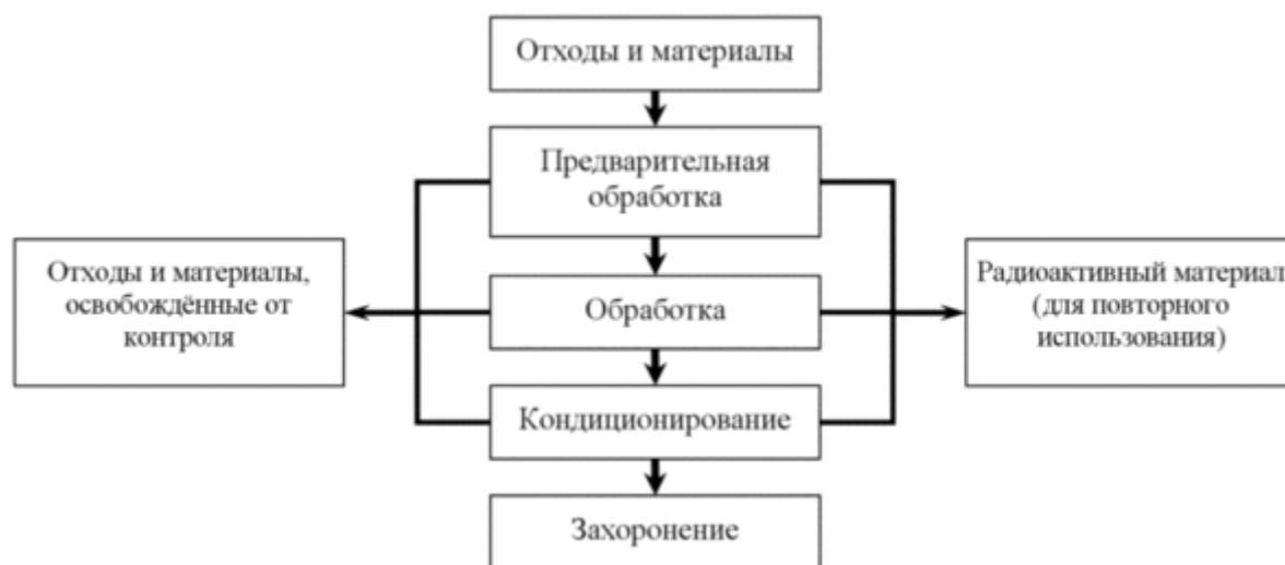
Рис. 2.1 – Основні етапи поводження з радіоактивними відходами
