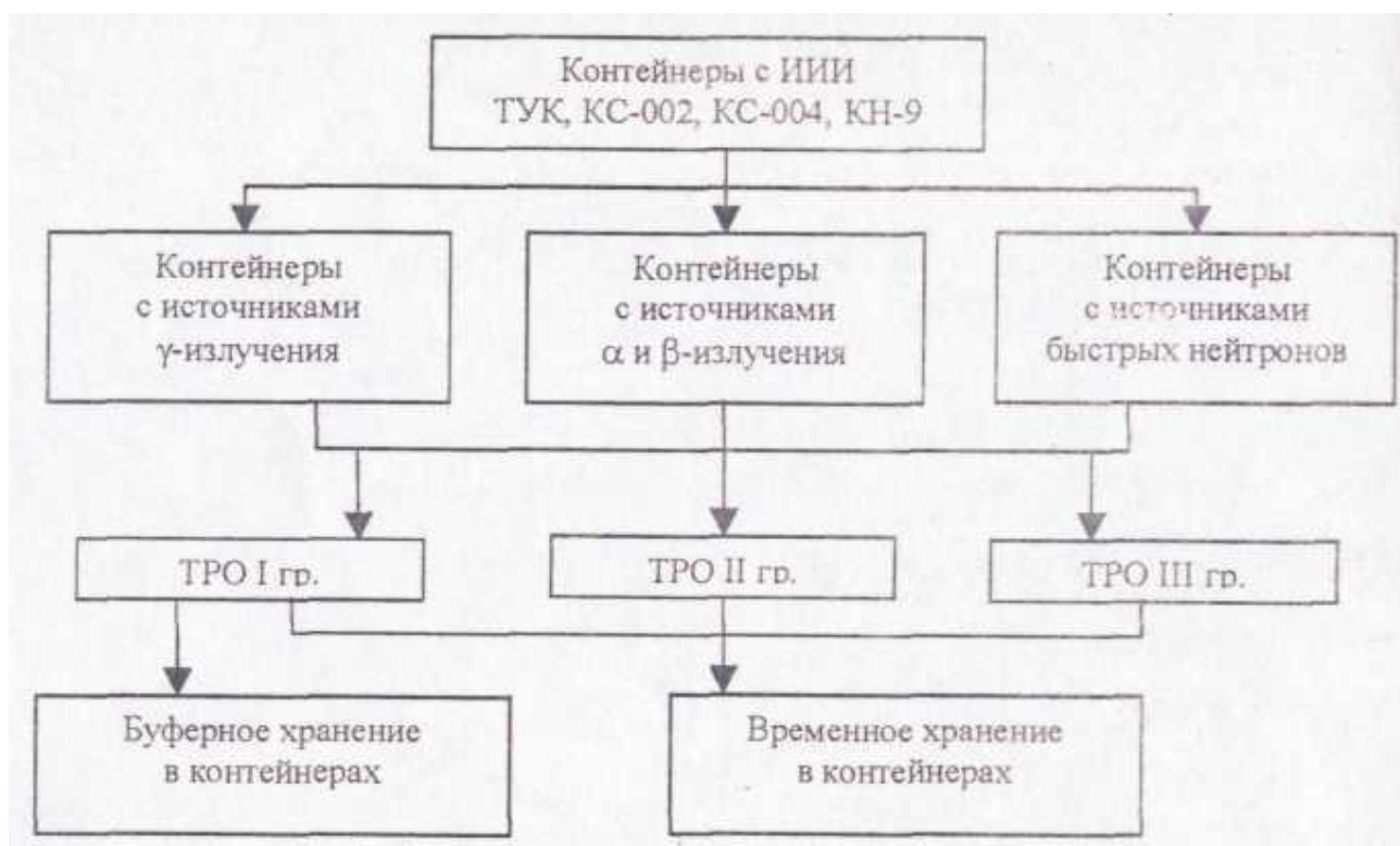
Рис. 3.6 – Принципова технологічна схема сортування ДІВ на ПЗРВ
