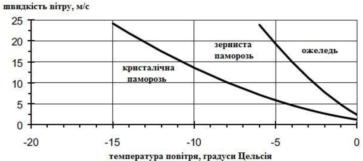
Рис. 1.2 – Тип відкладення як функція температури повітря та швидкості вітру
