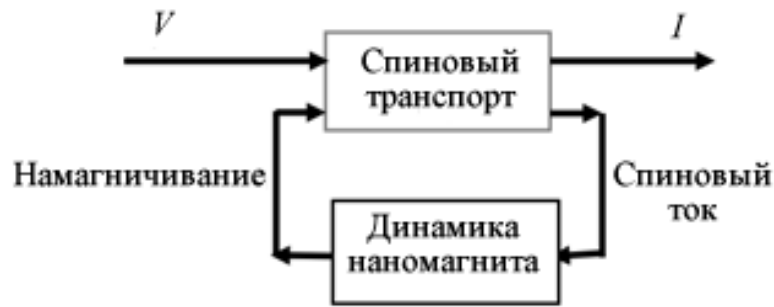
Рис. 14. Спиновый транспорт и динамика перемагничивания наномагнитов тесно связаны.
