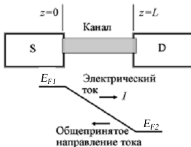
Рис. 3. К решению системы уравнений (6) и (15) с граничными условиями (16). Как и на рис. 16/гл.1, здесь и далее (§§ 7.2 – 7.4) используется направление тока S \rightarrow D в отличие от общепринятого направления.
