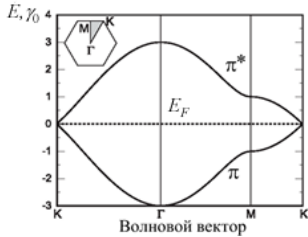
Рис. 3. Симметричная зонная структура графена в приближении Хюккеля: ( S = 0 ; \gamma_0 \neq 0 ).
