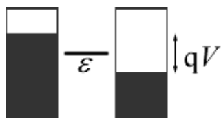
Рис. 18. После баллистического пролета электрона с истока на сток по каналу с энергией \varepsilon , на истоке выделяется энергия E_{F1} - \varepsilon , а на стоке – энергия \varepsilon - E_{F2} , и контакты снова находятся в равновесии.
