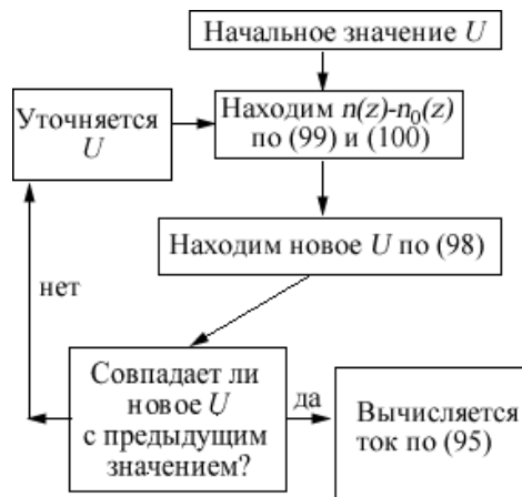
Рис. 30. Самосогласованная процедура вычисления потенциала проводника U и тока в расширенной модели проводника.
