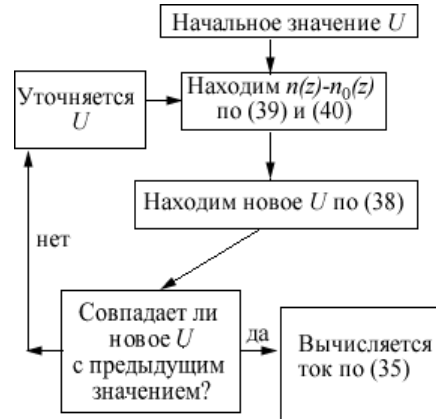
Рис. 15 – Самоогласованная процедура вычисления потенциала проводника U и тока в расширенной модели проводника.
