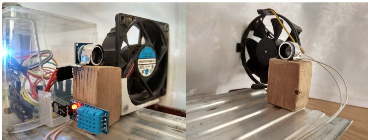
Рисунок 8.2 – Автоматизований електронний ультразвуковий анемометр на базі мікропроцесору Arduino 101
