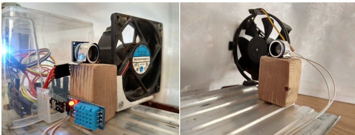
Рисунок 5.2 – Автоматизований електронний ультразвуковий анемометр на базі мікропроцесору Arduino 101
