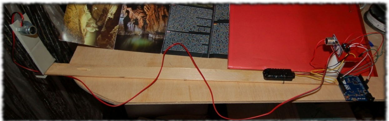
Рисунок 6.3 - Ультрозвуковий анемометр на одній парі датчиків
