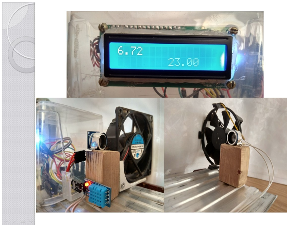
Рисунок В.9 – Ультразвуковий анемометр: дисплей, передавай та приймач
