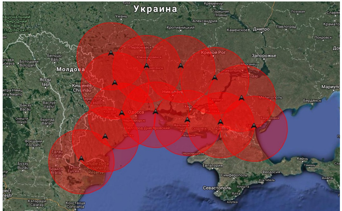
Рисунок 5.3 – Планування радіолокаційного поля при розстановці з багаторазовим перекриття зон в ArcGis
