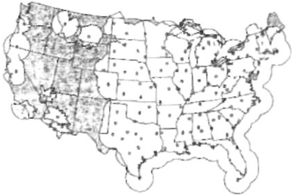
Рисунок 3.7 – Загальне радіолокаційне покриття на висоті 10 000 футів від місця установки радіолокаторів в суміжних штатах, що існував до введення NEXRAD, і розташування радіолокаторів типу WSR-57 і WSR-74
