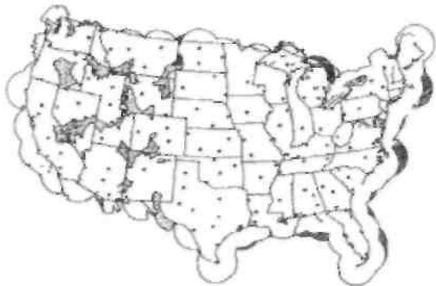
Рисунок 3.8 – Загальне радіолокаційне покриття радіолокаторами NEXRAD на висоті 10 000 футів від місця установки радіолокаторів в суміжних штатах і розташування станцій Національної метеослужби та міністерства оборони США. Заштриховані райони, де звужене покриття
