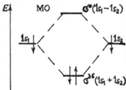
Рис. 3.2 – Енергетична діаграма атомних і молекулярних рівнів гідродену
