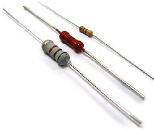
Рисунок 2.1 – Резистори з різним опором та маркуванням.
