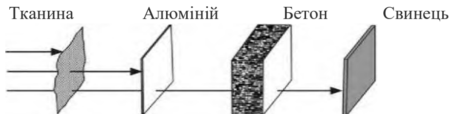
Рисунок 2.1 - Поглинання різних видів іонізуючих випромінювань різними матеріалами
