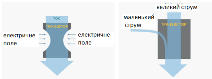
Рис. 21 – Принцип роботи біполярного та польового транзистора
