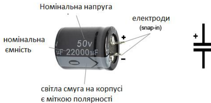
Рис. 8 – Маркування електролітичних конденсаторів
