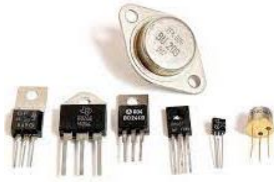
Рис. 17 – Дискретні транзистори у різному конструктивному оформленні
