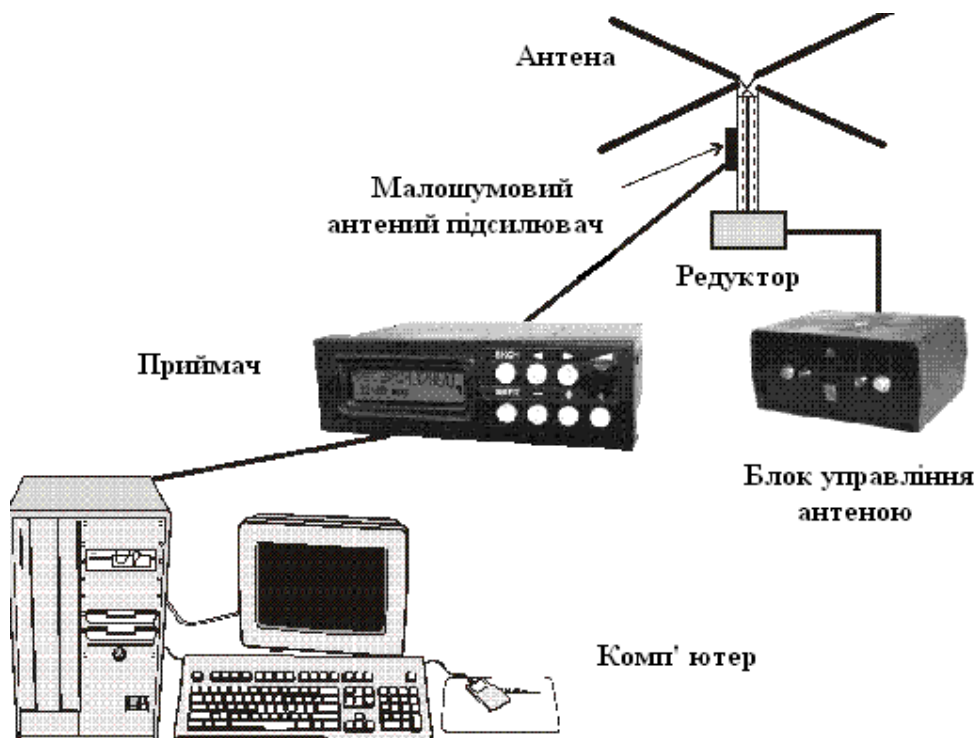
Рис. 1.11 – Склад наземного устаткування для прийому супутникового сигналу формату АРТ (існує комплектація без блоку управління антеною)
