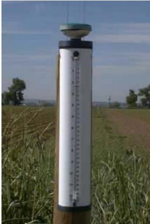
Рисунок. 2.3 – Атмометр розміщений між зрошуваними полями [10].
