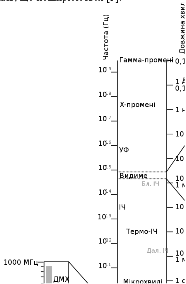
Рисунок 1.1 - Спектр електромагнітного випромінювання
