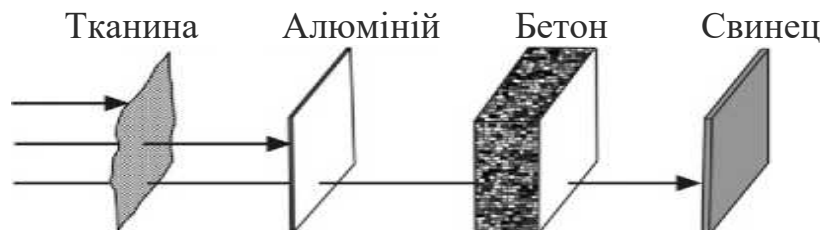
Рисунок 2.1 - Поглинання різних видів іонізуючих випромінювань різними матеріалами
