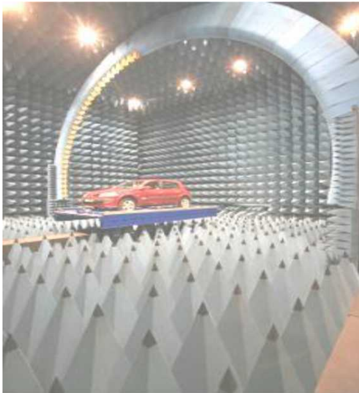
Рисунок 5.6 - НВЧ поглиначі (пірамідальні пустотілі радіопоглинаючі матеріали для безлужних камер великих розмірів та випробувань на електромагнітну сумісність)
