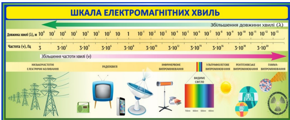
Рисунок 1.3 - Типи електромагнітних коливань
