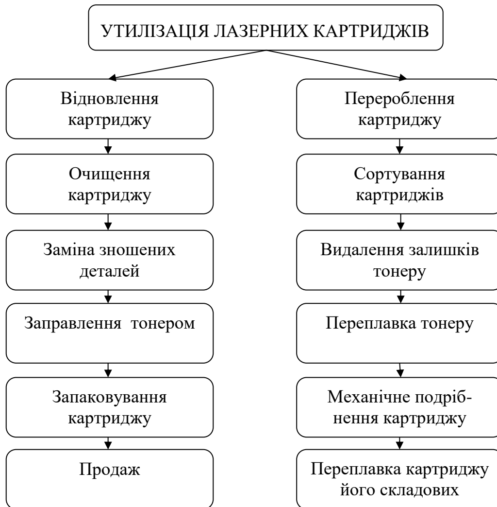
Рис. 3.12 – Етапи відновлення та перероблення лазерних картриджів
