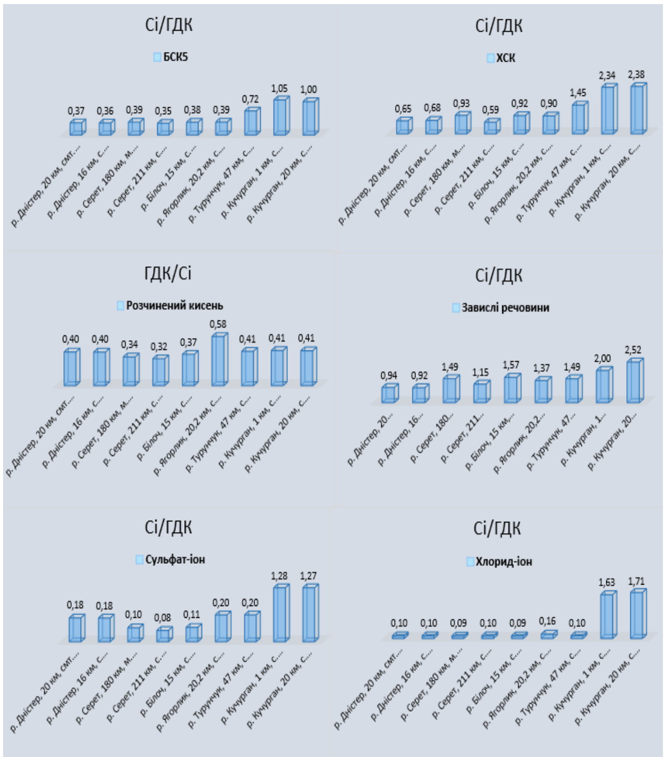
Рисунок 3.8 – Результати розрахунку середньорічних значень показника кратності перевищення ГДК для показників БСК 5 , ХСК, Розчиненого кисню, Завислих речовин, Сульфат- та Хлорид-іонів (басейн р. Дністер, 2022 р.) (за автором)
