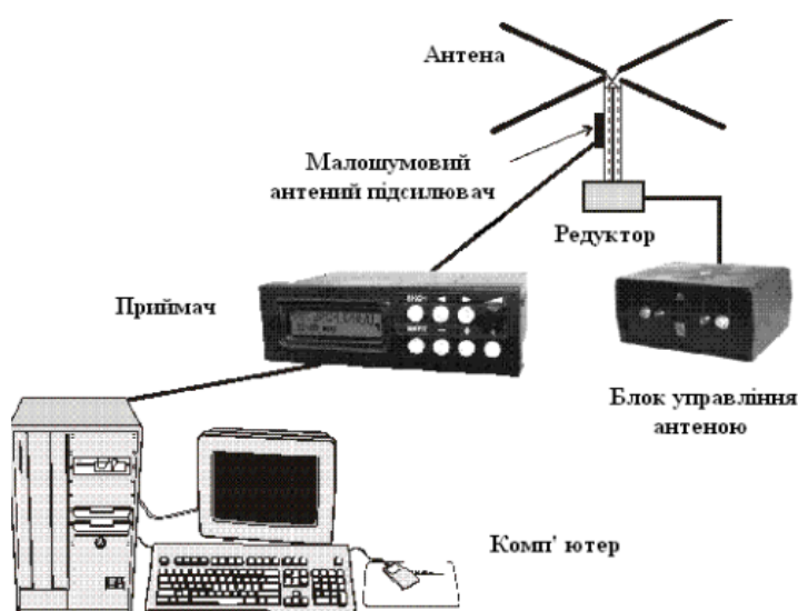
Рисунок 2.20 –Зберігання наземного обладнання для прийому супутникових сигналів у форматі ART
