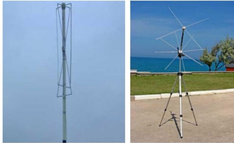
Рисунок 2.21 – Зовнішній вигляд антени для прийому супутникового сигналу формату АРТ (ліворуч – квадрофіляр, праворуч – вібратор)
