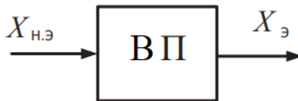
Рис. 2.1 – Структурна схема перетворення неелектричних величин
