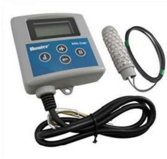
Рисунок 1.2 – Датчик вологості Hunter Soil-Clik
