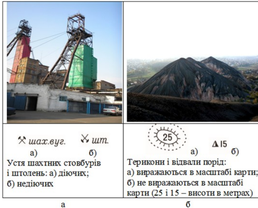
Рисунок 77 - Устя шахтних стовбурів і штолень, над якими на місцевості встановлені копри (а) і терикони (б) та їх зображення на картах
