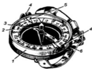
Рисунок 40 - Компас Адріанова: 1 - корпус; 2 - шкала (лімб);
