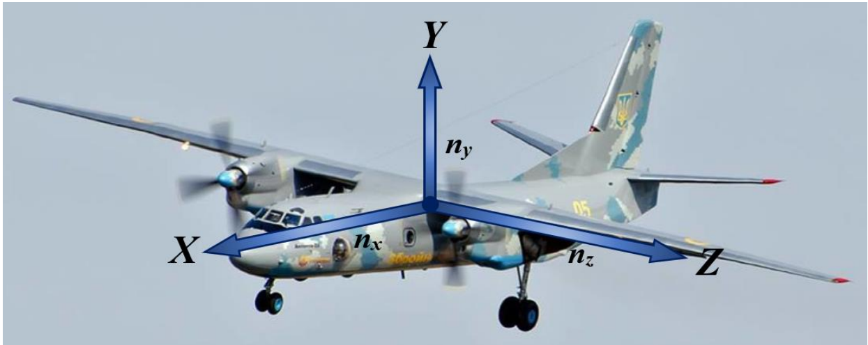
Рисунок 3.11 – Повне перевантаження та її складові за осями
