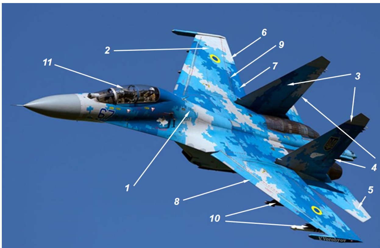
Рисунок 1.1 – Основні частини літака: 1 – фюзеляж; 2 – крило; 3 – вертикальне оперення (двокриле); 4 – руль напрямку; 5 – стабілізатор; 6 – елерон; 7 – руль висоти; 8 – передкрилок; 9 – задкрилок; 10 – пілони для підвіски озброєння (балочні утримувачі); 11 – ліхтар
