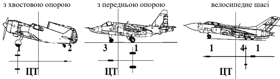
Рисунок 1.5 – Схеми шасі: 1 – основні колеса; 2 – хвостове колесо; 3 – носове колесо; 4 – підкрильні колеса; ЦТ – центр тяжіння
