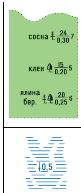
Рисунок 4.18 – Приклади пояснювальних умовних знаків , які вказують породу лісу і кількісні характеристики, що позначають середню висоту, середню товщину дерев та густоту лісу ( зверху ), а також середню глибину боліт ( знизу )
