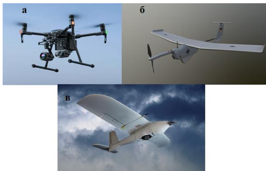
Рис. 10 – Моделі міні-дронів: а – квадрокоптер dji matrice 200 v2, б – БПЛА літального типу Aladin, в - БПЛА літального типу Lockheed Martin Desert Hawk III.
