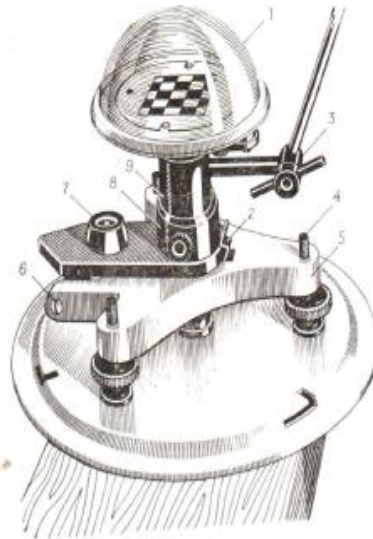
Рисунок 6.6 - Піранометр термоелектричний універсальний М-80М: 1 – головка М-115м; 2 - стопорна пружина; 3 – шарнір затінювача; 4 - установочний гвинт; 5 - основа; 6 – шарнір відкидного штативу; 7 - рівень; 8 – гвинт; 9 стоек з осушувачем всередині
