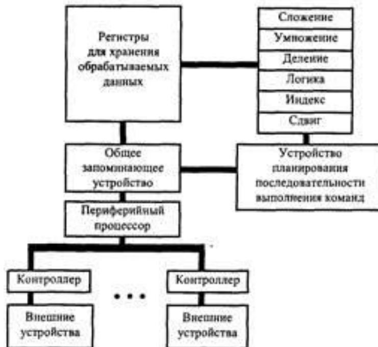
Рисунок 6.5 Архітектура магістрального суперкомп'ютера
