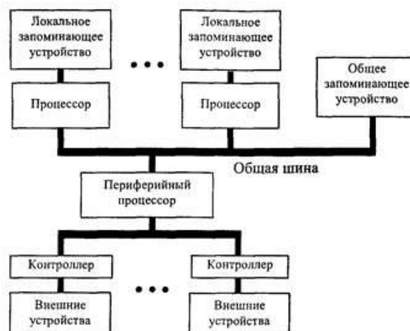
Рисунок 6.4 Архітектура багатопроцесорної обчислювальної системи із загальною шиною
