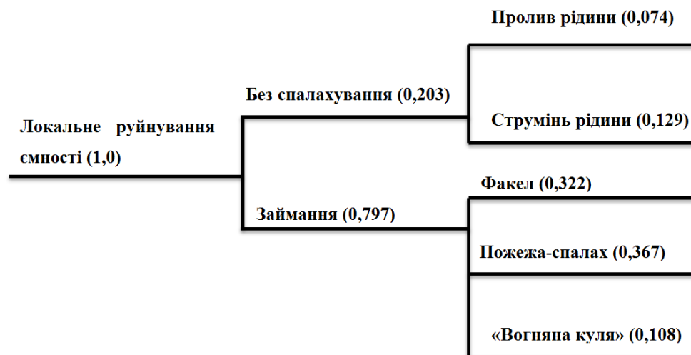
Рисунок 14.3 Аналіз розвитку НС на АЗС внаслідок руйнування ємності за допомогою “дерева подій”
