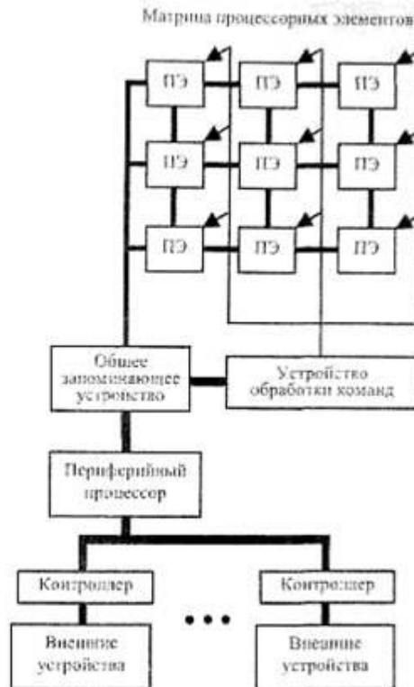
Рисунок 6.6 Архітектура матричної обчислювальної системи з загальним управлінням
