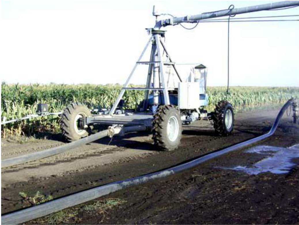
Рисунок 3.2 - Загальний вигляд центрального візка дощувальної машини «Centerliner 168 CLS»
