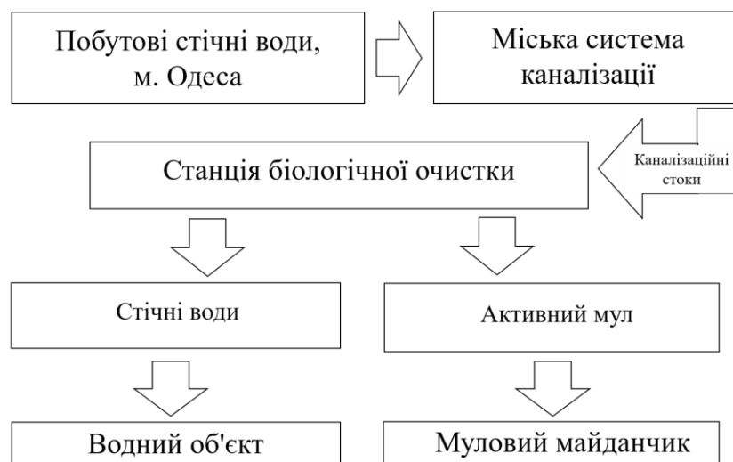
Рисунок 4.14 – Принципова схема надходження ПХДД/Ф у морське середовище при скиданні січних вод очисними спорудами Одеської ПМА
