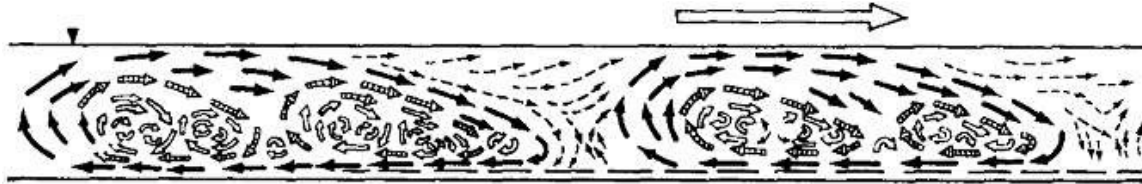
Рис. 1.5 – Схема кінематичної структури турбулентного потоку за А. Б. Клавеном [1].
