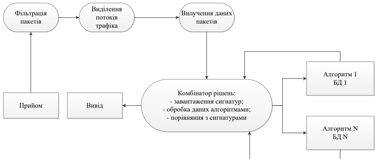
Рисунок 3.1 – Аналіз пакетів DPI з використанням комбінатора рішень
